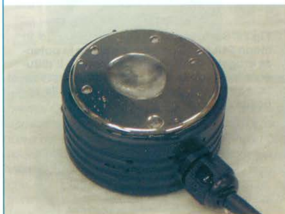
Fig.27 Nel generatore di ultrasuoni a 3 MHz invece, l'acqua non viene più vaporizzata bensì concentrata verso il centro del trasduttore, come indicato in figura.
