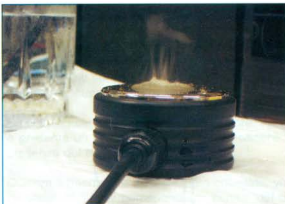
Fig.26 Nel generatore di ultrasuoni a 1 MHz. ponendo una goccia d'acqua sulla superficie del trasduttore si ottiene un effetto di vaporizzazione ben visibile.
