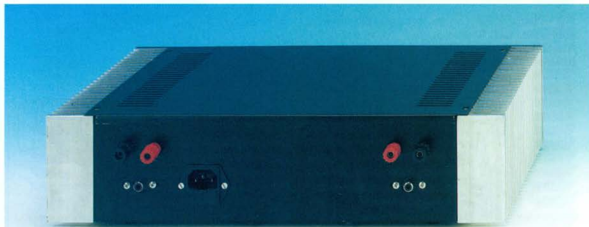
Fig.14 Sul pannello metallico posteriore dovete montare le boccole d'uscita per gli altoparlanti, le prese di BF per l'entrata del segnale e la presa di rete a vaschetta.
