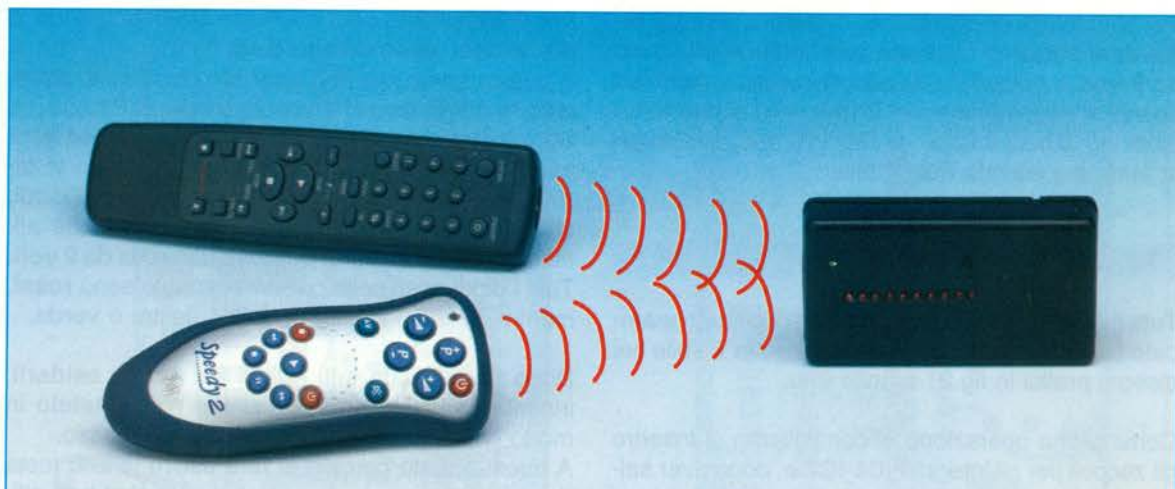
Fig.24 Per controllare se il vostro rivelatore di raggi infrarossi funziona, basta prendere qualsiasi telecomando a raggi infrarossi e porlo a circa 10 cm dal foro, in corrispondenza del diodo BPW.41. Agendo sul pulsante P1 e sui tasti del telecomando vedrete accendersi i diodi led rossi. Più vi allontanate dal telecomando, meno diodi led si accenderanno.
