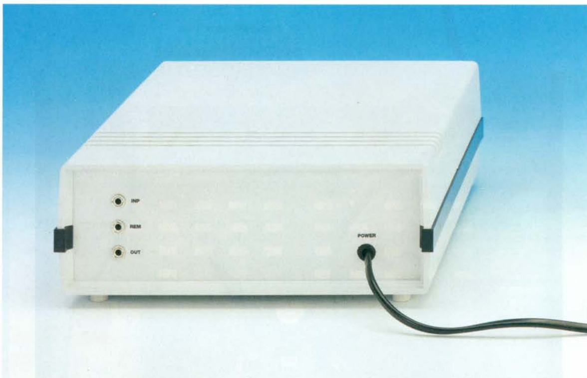
Fig.24 Nella foto è visibile il pannello posteriore del generatore sul quale si possono notare i connettori contrassegnati dalla dicitura INP, REM, OUT che consentono di collegare tra loro i generatori in cascata. Al connettore REM va collegato il pulsante Remote, che consente di interrompere in qualsiasi momento la sessione.
