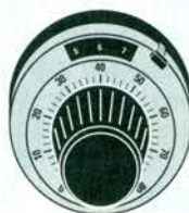
Fig.6 Con il potenziometro multigiri, è possibile misurare con precisione il Delay Time , cioè la distanza tra l'inizio della traccia e il punto nel quale si trova quella parte di segnale che si desidera espandere.
