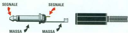
Fig.4 Negli spinotti jack Mono il segnale BF fa capo alla testa dello spinotto e la massa al cilindro metallico esterno.
