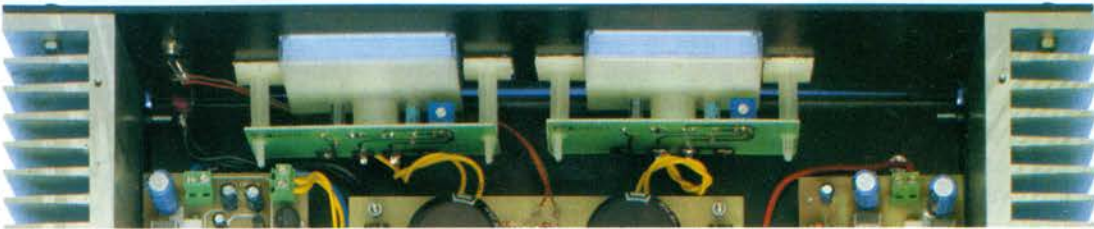
Fig.19 Particolare del montaggio dei due strumentini Vu-Meter siglati LX.1115 (uno per ogni canale) fissati al pannello frontale del mobile con i distanziatori autoadesivi.
