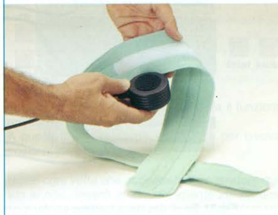
Fig.28 Prima di posizionare il trasduttore sulla parte prescelta applicate sul suo corpo il ritaglio di velcro adesivo per effettuare il fissaggio alla fascia applicativa.
