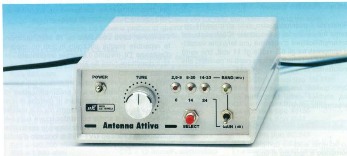
Fig.1 Ecco come si presenta il mobile della Centralina di Comando LX.1657 che andrà collocato vicino al ricevitore che si vuole sensibilizzare (vedi fig.2). Il deviatore a levetta S1 e il pulsante Select permettono di selezionare la Banda e il Guadagno.
